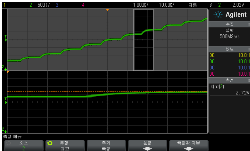
그림 45 최고값 측정을 위한 영역 격리
