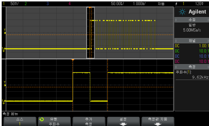
그림 47 주파수 측정을 위한 이벤트 격리
